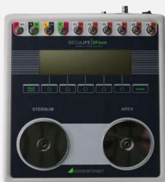
Analizador de desfibriladores para pruebas de funcionamiento de desfibriladores externos.
