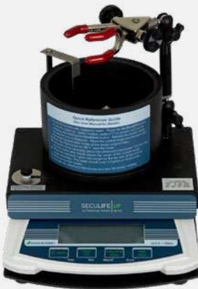
El modelo de medidor de potencia ultrasónica SECULIFE UP está pensado para comprobar transductores diagnósticos y terapéuticos.
