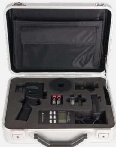
Para tareas de medición exigentes en el campo de la medicina, como los ensayos de aceptación y constancia según las normas DIN 6868-57/6868-157 para pantallas de diagnóstico, así como mediciones en sistemas de visualización de imágenes, como estos:
